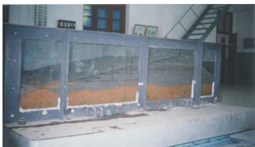
图 3 灰坝模型实物图 Fig. 3 Model of fly-ash dam for testing
