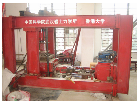
图 1 改装后的大型直剪仪
