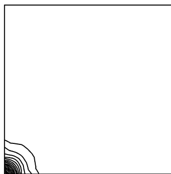
图 12 640 年时水平剖面上浓度等值线 (单位: \text{mol}/\text{m}^3 )
