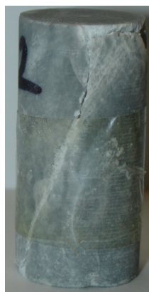
图 3 单轴压缩破坏后试样照片
