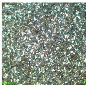
(a) 砂岩试件的显微结构照片 1
