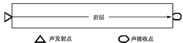
图7 弹性波透射法测试
