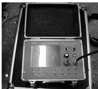
图 2 EMS-2 型工程多波地震仪
