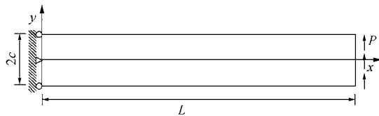
图 4 受端部荷载作用的悬臂梁
