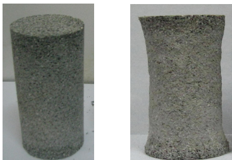
图 5 泡沫混凝土静水压破坏形态
