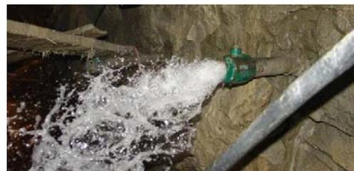
图 11 雷达探测含水裂隙带出水照片
