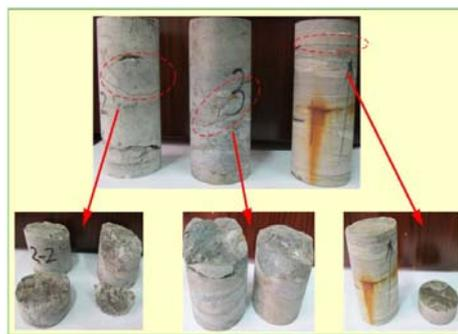
图 6 冻融试验岩样破坏形态
