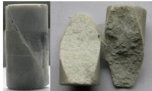
图 7 岩石蠕变破坏后的形态和断裂面
