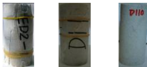
(a) 拉伸破坏 (b) 细观拉伸、宏观剪切破坏 (c) 剪切破坏
