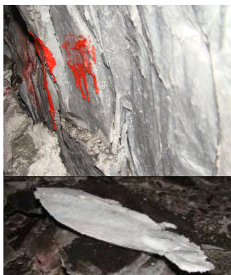
图 7 试验支洞 C 中的楔形板状破坏
