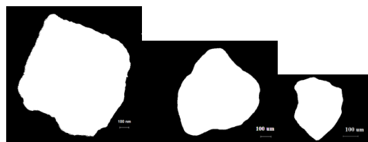
图 8 颗粒的二值化图像 Fig.8 Binary image of the particle
