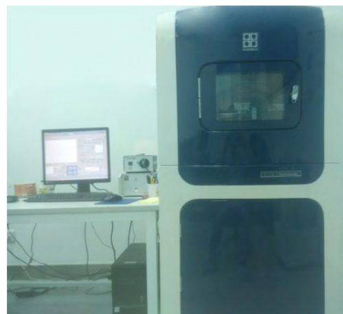
图 1 Hysitron 纳米压痕测试系统
