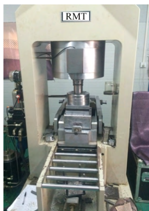
图 5 RMT 试验加载系统 Fig.5 The RMT test loading system
