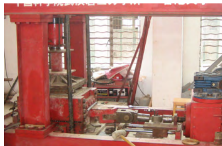
图 6 直剪试验设备
