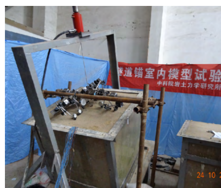
图 3 模型试验箱、反力框架和拉拔千斤顶
