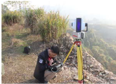
图7 莱卡三维激光扫描仪 HDS8800 Fig.7 Leica HDS8800
