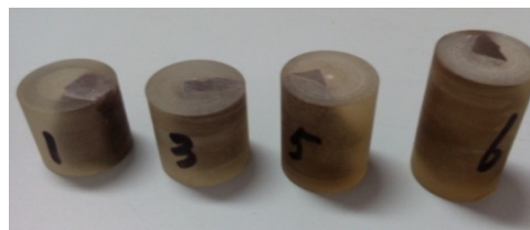
图 1 加工完成的人工合成试样 Fig.1 Synthetic samples after machining
