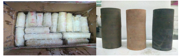
图 3 样品钻取制备图 Fig.3 Prepared rock samples
