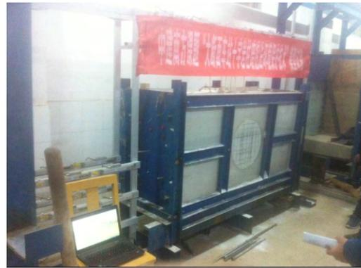
图 6 浇筑完成的试验模型
