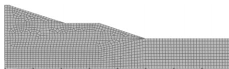
图 8 1 号拦污坝模型 Fig. 8 1# barrier dam model
