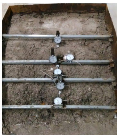
(b) 表面崩塌破坏图
