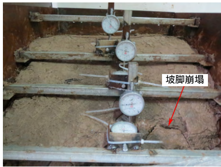
(a) 试验完成后膨胀岩边坡变形破坏图
