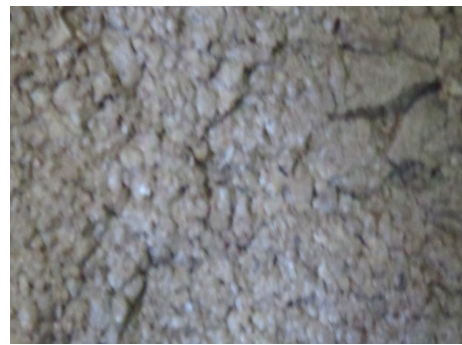
(b) 膨胀岩崩解成鳞片状碎屑物图
