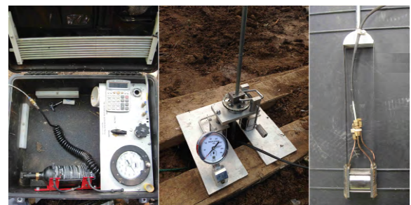
(a) 控制箱 (b) 剪切盘 (c) 剪切探头
