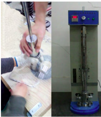
图7 最大干密度的手动测试法和电动测试法 Fig.7 Manual and electric test methods of maximum dry density
