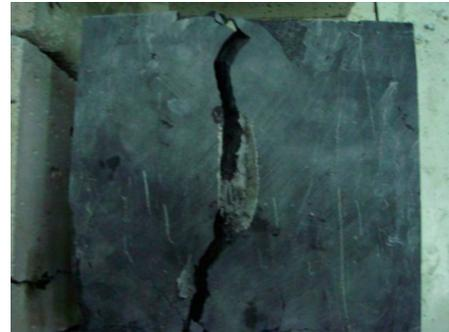
(a) 无侧限试验泥岩试样破坏形态
