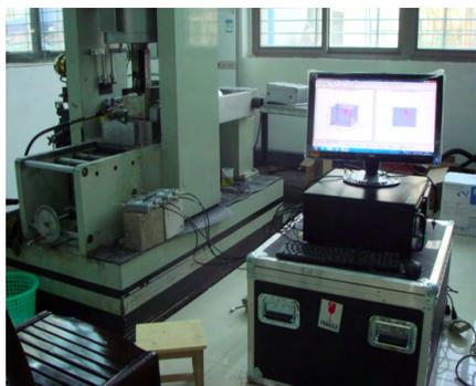
图 1 岩石贯入试验加载系统
