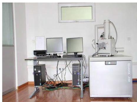
图 3 Quanta 250 型扫描电子显微镜
