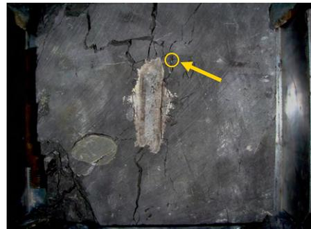
(b) 有侧限试验泥岩试样破坏形态
