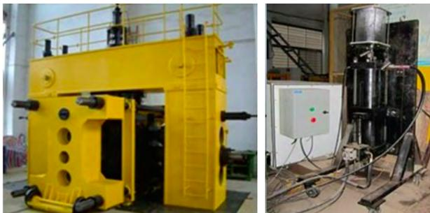
图3 真三轴水力压裂物理模拟试验系统
