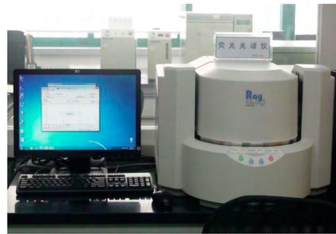
图 3 X 射线荧光光谱仪
