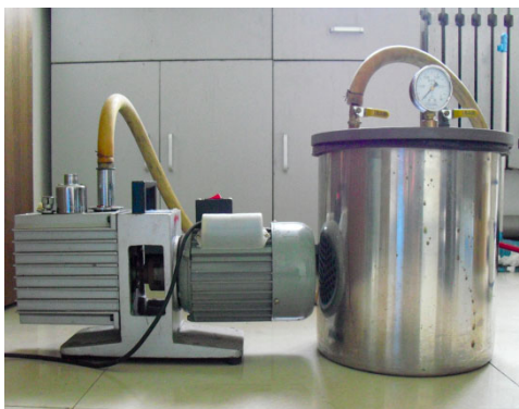
图 4 试样在真空状态下吸水至饱和状态
