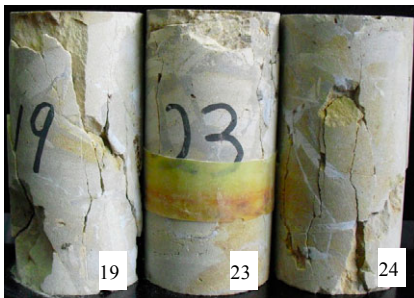
图 15 天然状态试样单轴压缩破坏形态
