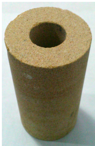
图 1 厚壁圆筒石英砂岩试样
