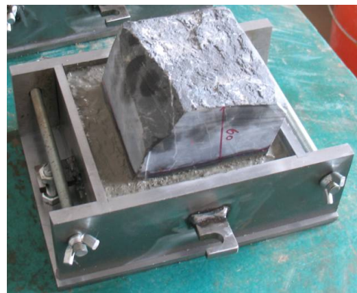
(c) 水泥砂浆浇筑及模具
