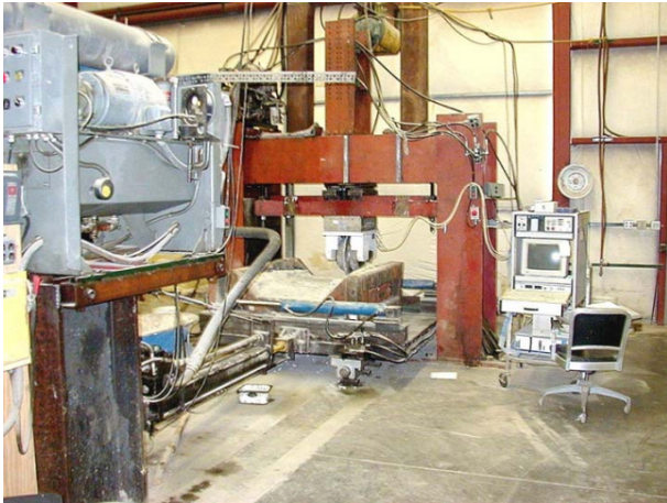
图1 室内全尺寸线性切割试验设备 [28]
