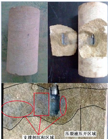
图 9 裂缝面支撑剂的浓度分布
