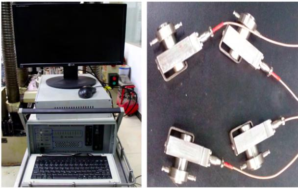
图 3 声发射系统及探头
