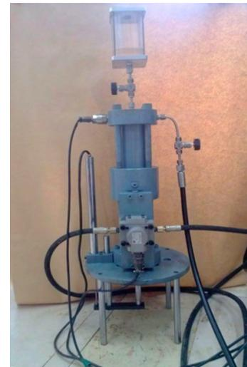
图 2 压裂泵伺服控制系统
