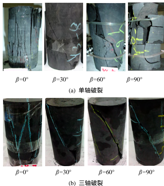
图 7 典型的页岩试样破裂样式图
