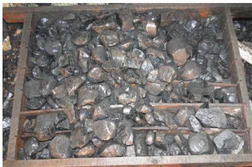
图 18 柱状节理岩体的钻孔取芯状况
