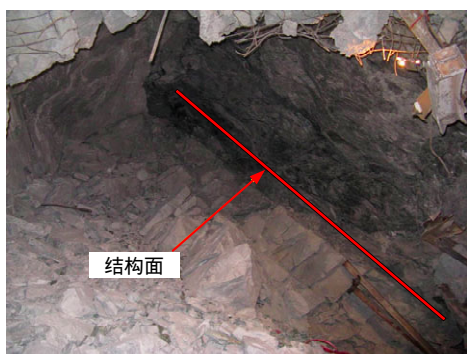
图 5 “11·28” 极强岩爆爆坑和揭露的结构面
