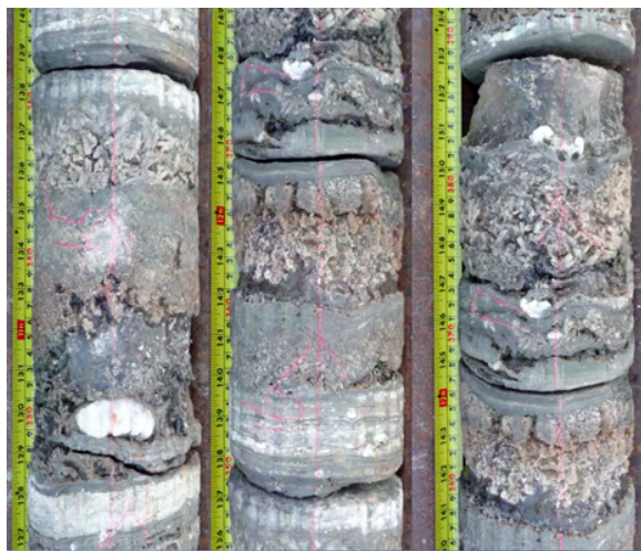
图 9 产生于泥岩处断裂
