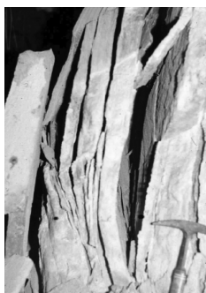
图 9 板裂化岩体变形 [49]
