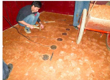
图 3 土压力计埋设过程
