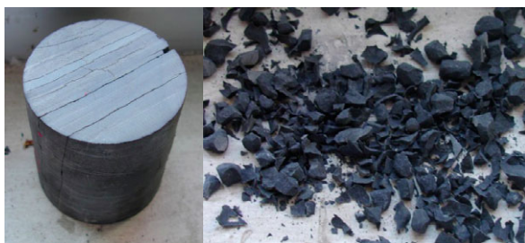
图 3 泥岩遇水崩解试验图片
