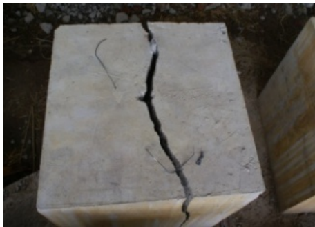
图 15 爆破开裂结果 Fig.15 Cracking in blasting
