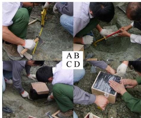
图 2 冰碛土原状样取样过程
