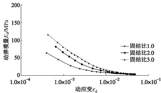
图 11 重塑红黏土动弹模量试验曲线(固结比影响)
