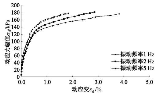
图8 重塑红黏土  $\sigma_d - \epsilon_d$  试验曲线(振动频率影响)
