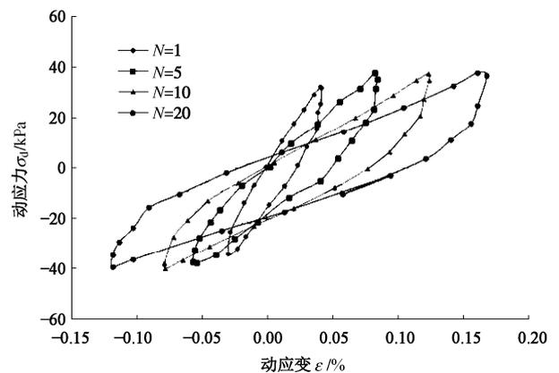
图 3 循环荷载作用下土体应力应变关系
