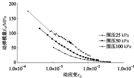
图 10 重塑红黏土动弹模量试验曲线(围压影响)
