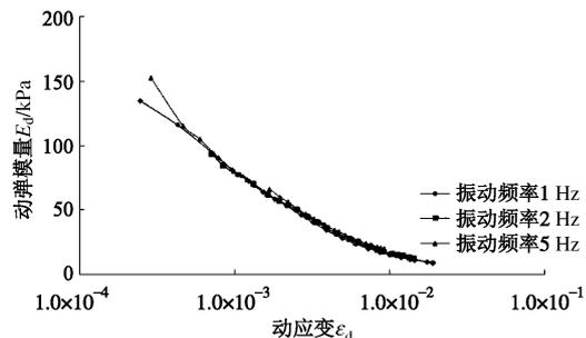
图 12 重塑红黏土动弹模量试验曲线(振动频率影响)
