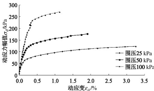
图6 重塑红黏土  $\sigma_d - \epsilon_d$  试验曲线(围压影响)
