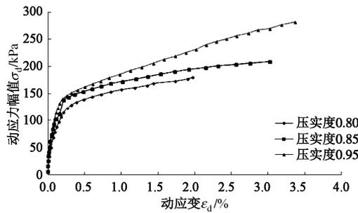
图5 重塑红黏土  $\sigma_d - \epsilon_d$  试验曲线(压实度影响)
