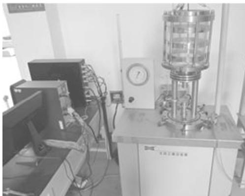
图 1 SDT-10 型动态三轴测试系统
