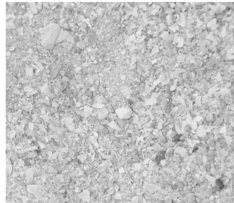
图 2 贝壳砂典型颗粒形状
