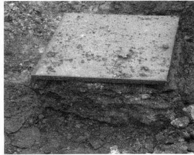
图10 土石混合体压剪试验的现场照片
