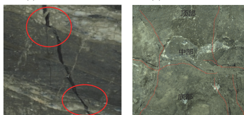
(c) 中部裂纹转折
