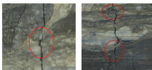
(a) 上部裂纹转折
