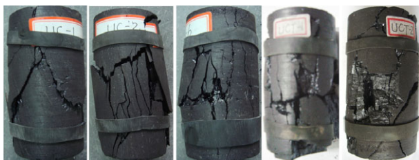
图9 煤样平行于层理面方向单轴压缩破坏状态
