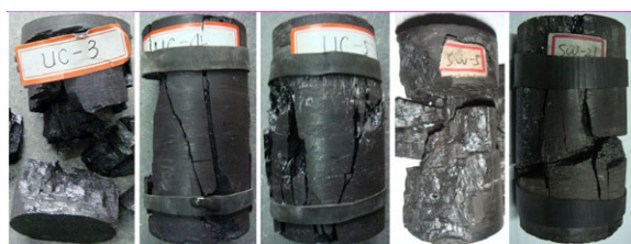
图 7 煤样垂直于层理面方向单轴压缩破坏形态
