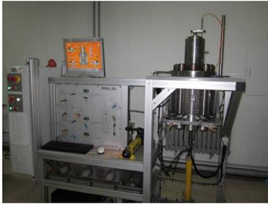
图 3 TRIAXIAL CELL V2 高压三轴仪
