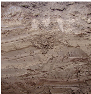
图 4 粉土层剖面图
