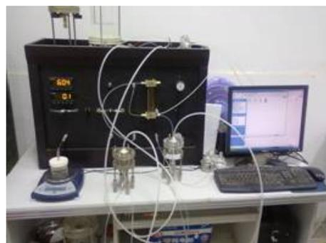
图 2 伺服流速渗透仪
